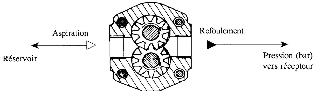
IV – La pompe est entraînée en rotation par une **prise de mouvement** (2) généralement flasquée directement sur la boîte de vitesse du véhicule. La liaison arbre de pompe / prise du mouvement étant obtenue par un accouplement.
